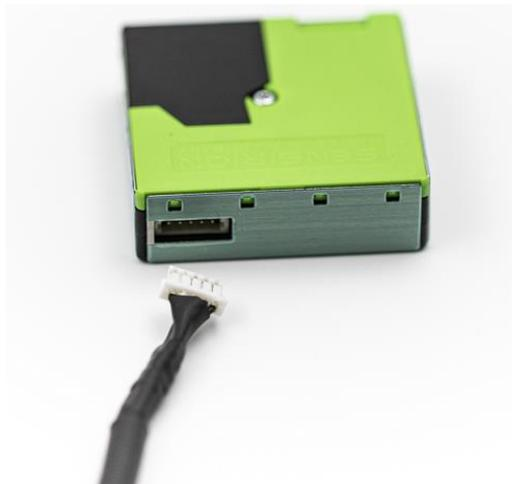
Abbildung 3: Anschluss Sensorkabel an Partikelsensor
