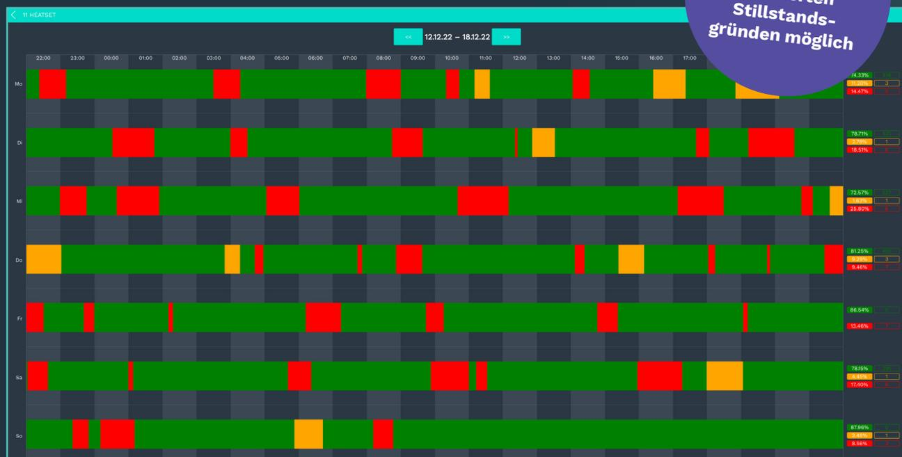
Beispieldarstellung einer Fräsmaschine mit Stillstands- und Produktivzeiten inkl. Stückzählung
