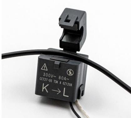
Abb. 7: Geöffneter Stromsensor mit stromführendem Kabel
