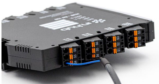
Abb. 5: Anschlussleitung am HUB-EN100 (beispielhaft als Sensor 4 (S4) geklemmt)
