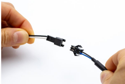
Abb. 6: Anschlussleitung und Stromsensor verbinden
