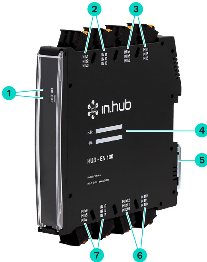
Abb. 1: Seitenansichten und Vorderansicht des HUB-EN100 inkl. Schnittstellen (beispielhafte Darstellung)
